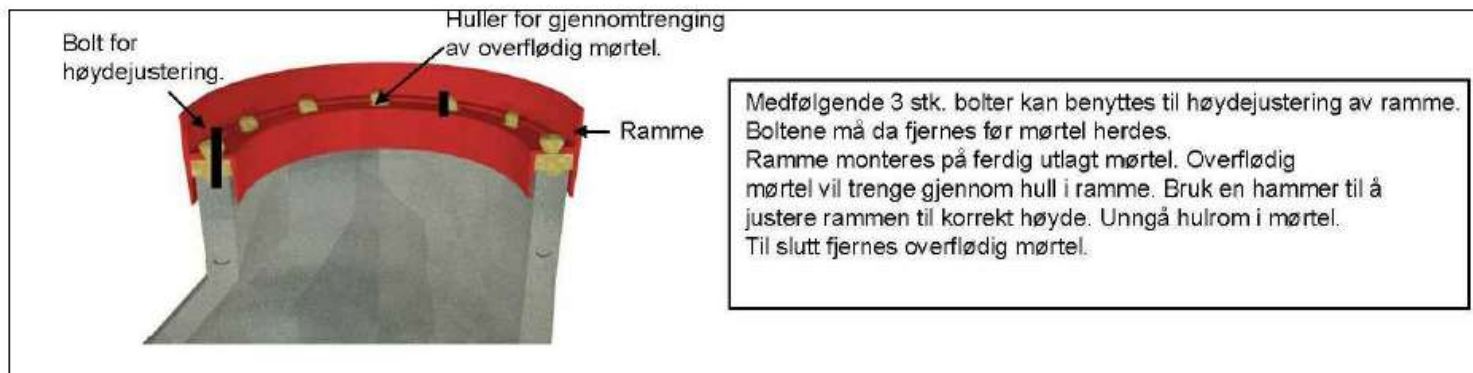
RAMME FOR MONTERING AV KUMTOPP
