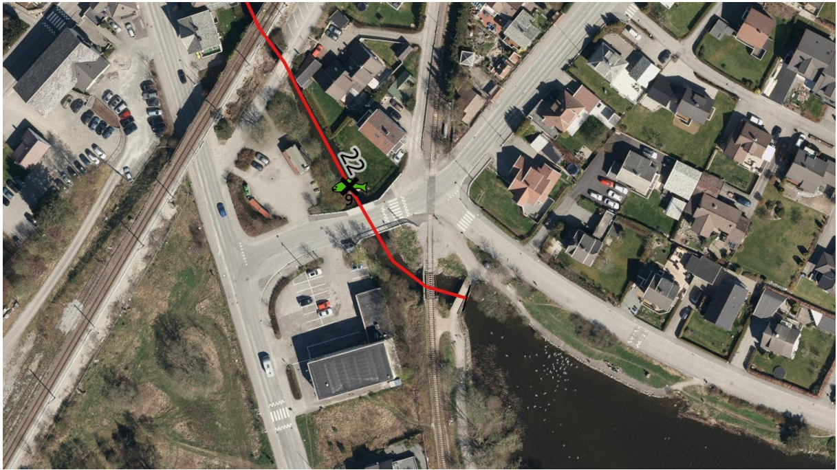
Figur 0.35: Hinder 9 i Storåna nedstrøms Hoveveien, i sone 22. Hinderet er en flat betongterskel som hindrer passasje av mindre fisk.
