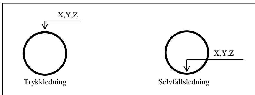
Figur 1. Måling av ledningshøyde.
