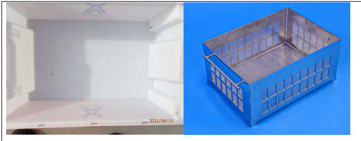
Figur 3.2. Kvit bakke for sediment prøve og sil med runde hull.
