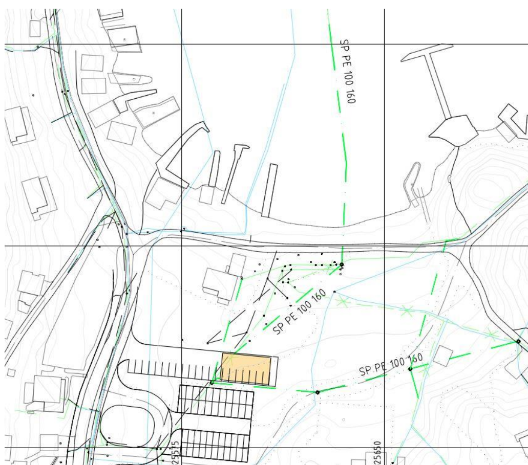
Figur 7. Forslag til plassering av slamavskilleranlegg under regulert offentlig parkeringsplass.
