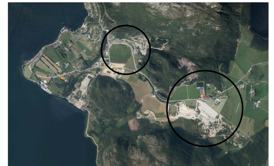
2019. Hovedferdselsåre i øst-vest retning utvides og vei omdirigeres slik at den går utenom utvidet sanduttak
