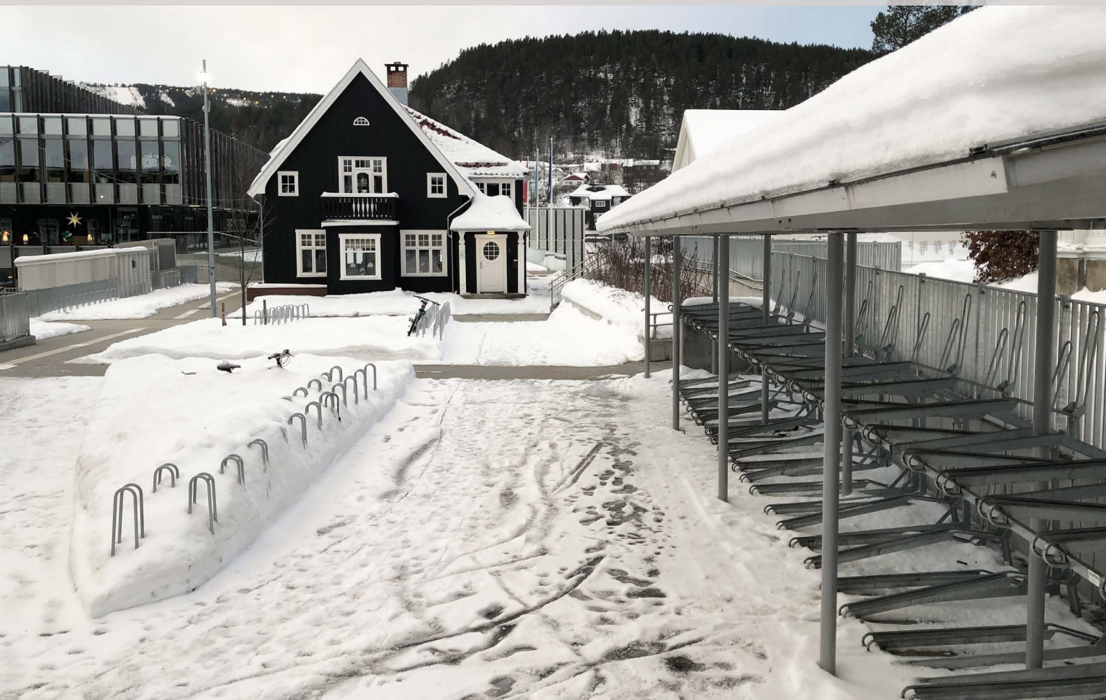
En del typer stativer er utfordrende å vedlikeholde ved snøfall (til venstre). Riktig type stativ eller overdekt parkering sikrer helårstilbud (til høyre). Sykkelparkering på Kronsberg kultur- og kunnskapssenter. Foto: Christoffer Olavsson Evju
